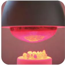
2.3/ Sécher sous une lampe à infra rouge à une distance de 80 à 100 mm pendant 20 à 50 min.
